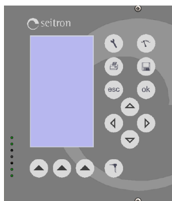
Tastiera con tasti preformati con funzioni di comando principali.
